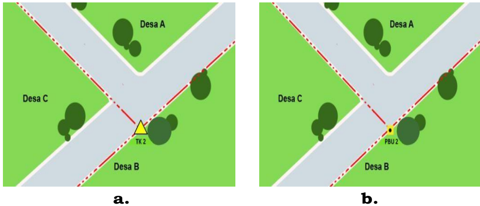
Gambar 7. a. Titik perpotongan Batas yang berada pada pertigaan jalan dilakukan pemberian Titik Kartometrik atau, b. Jika disepakati dapat dipasang PBU
